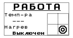
Здесь отображается текущее значение температуры воздуха (при использовании термопары) и факт включения ТЭНов. Символ **©** в правом нижнем углу обозначает готовность к пуску.
