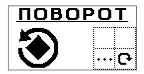
При этом контролируется срабатывание концевика начального положения, подключённого ко входу IN2. В случае превышения тайм-аута срабатывания концевика контроллер переходит в режим «АВАРИЯ».
