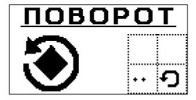
Уменьшающееся количество точек в правом нижнем углу обозначает оставшуюся величину там-аута срабатывания концевика. Если за это время срабатывания не произойдёт, контроллер автоматически обесточит двигатель и переведёт контроллер в режим «АВАРИЯ».
