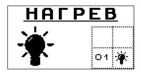
В правом нижнем углу отображается оставшееся время работы галогеновых ламп. По истечению данного времени лампы выключаются, а двигатель начинает дальнейший поворот детали в начально положение:
