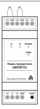
Он производит их оцифровку с автоматической компенсацией «холодного спая» и передаёт измеренное значение температуры в контроллер.
