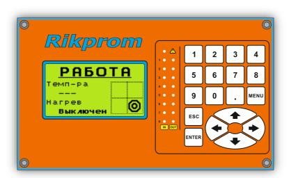
На лицевой панели контроллера расположен графический ЖК-индикатор и 17 светодиодов. Светодиоды с номерами 1...8 в группе «IN» и 1...8 в группе «OUT» отображают состояния соответствующих входов и управляющих линий. При этом номера с 1 по 4 в группе «OUT» соответствуют электромагнитным реле, а номера с 5 по 8 – дискретным цифровым выходам.
