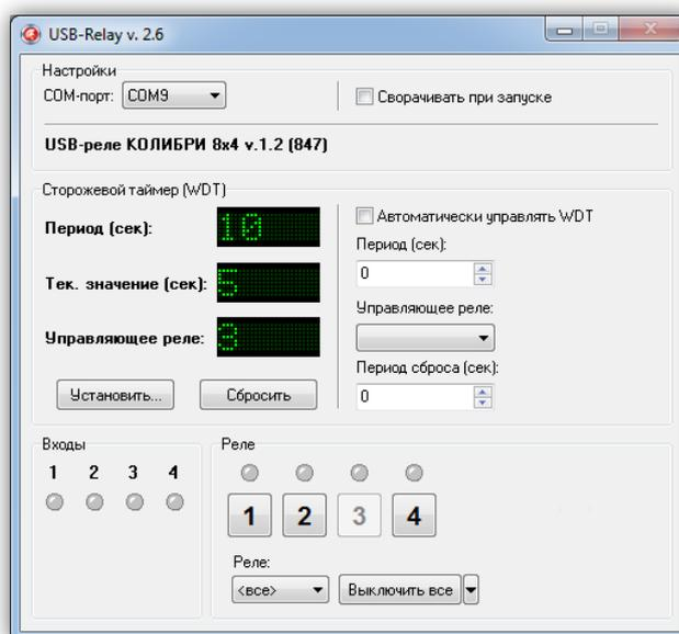
Как только его значение достигнет значения периода («Период (сек)»), будет включено выбранное реле на время 2 сек. После этого сторожевой таймер автоматически выключится.
