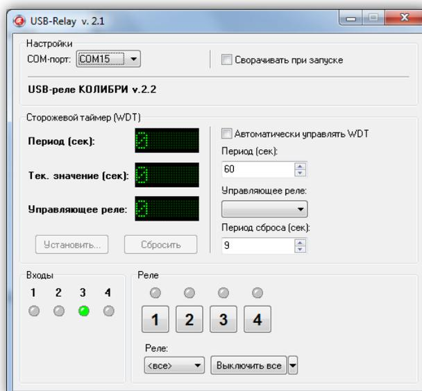
Управление электромагнитными реле может осуществляться двумя способами. Можно
