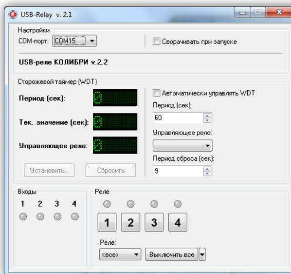
После запуска необходимо выбрать COM-порт, соответствующий USB-реле. Если порт был выбран верно и устройство исправно, программа будет отображать текстовое название устройства.
