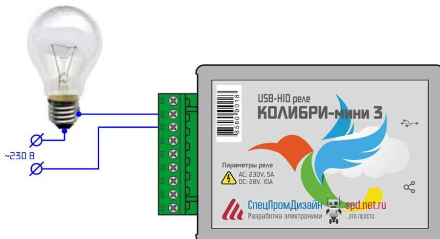
При получении команды от компьютера на включение реле, контакты замыкаются и через нагрузку начинает течь ток:
