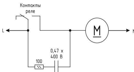
Иногда при малых мощностях нагрузки достаточным будет использование только одного конденсатора:
