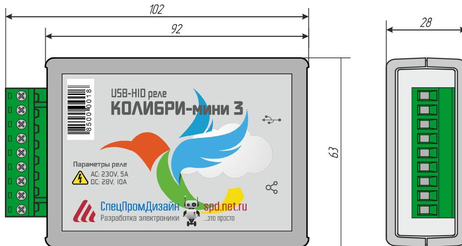
Подключение внешних цепей осуществляется при помощи разъёмного клеммника.
