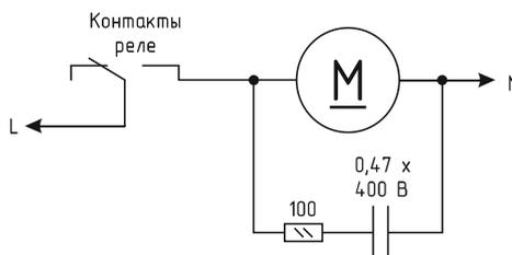
В случаях, когда затруднительно подключить такую цепь к обоим контактам нагрузки, можно подсоединить её параллельно самим контактам реле:
